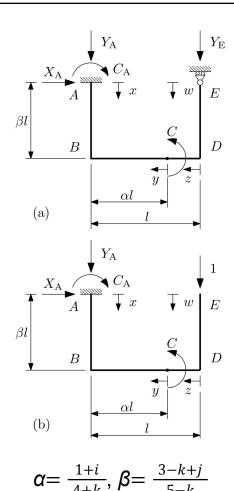
Considerare la struttura staticamente indeterminata di figura (a), caricata dalla coppia concentrata *C*.
