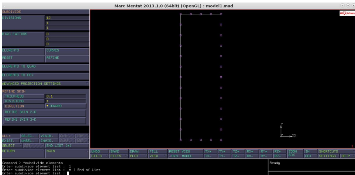
Figura 5 - Sezione a C suddivisa negli elementini di taglia di circa 10 mm
