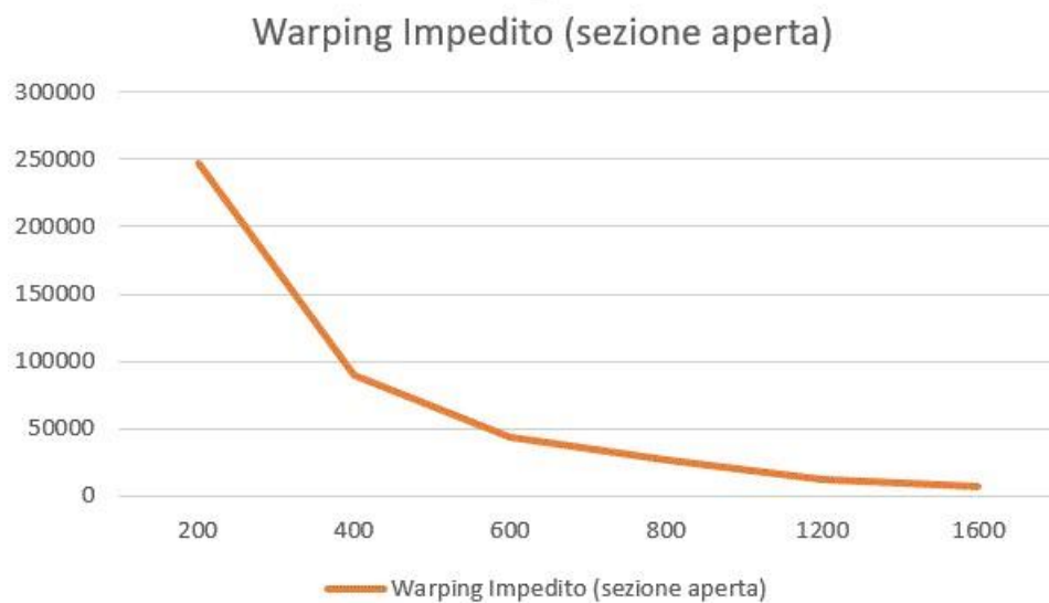
Figura 12: Sulle ascisse la lunghezza del profilato, sulle ordinate i valori di rigidezza trovati.
